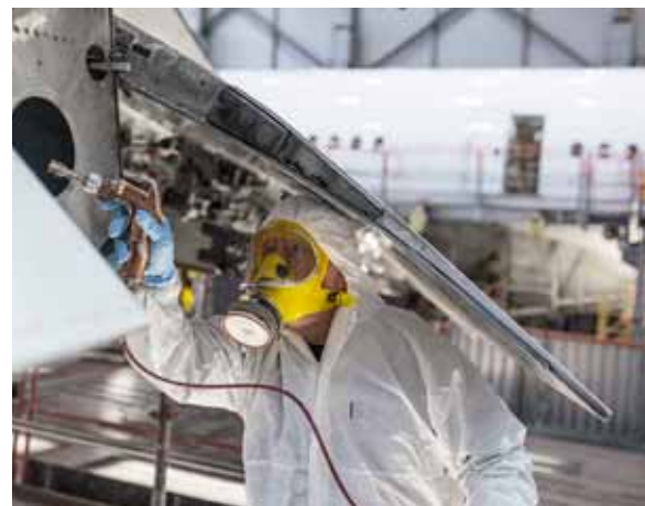
Ohne Strom: Wenn Paul Spalek Rostschutz versprüht, müssen alle anderen Arbeiten am Flugzeug (wie hier an einem Airbus A 340) ruhen und der Strom abgeschaltet sein
