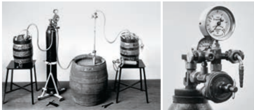
„Das Erfinden ist die Tätigkeit der Fantasie, Neues zu gestalten“, so Bernhard Dräger, Sohn des Firmengründers. Erster Ertrag dieser Kreativität: ein Druckminderer-Ventil
